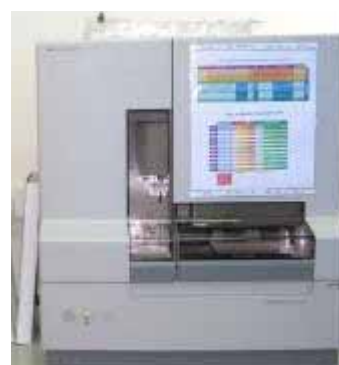
Séquenceur automatique à 16 capillaires (ABI 3130xl)
